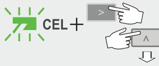
Menu di setup Elettrodo alla cellulosa
