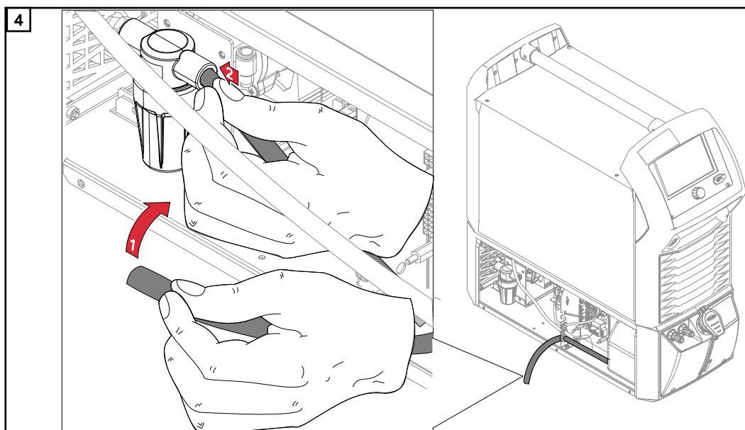
4 Вставте шланг охолоджувальної рідини у фільтр попереднього очищення для охолоджувальної рідини
