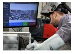
逐步指导:显示屏按定义的顺序直观显示每个工作步骤,并自动设置相应的焊接参数。
