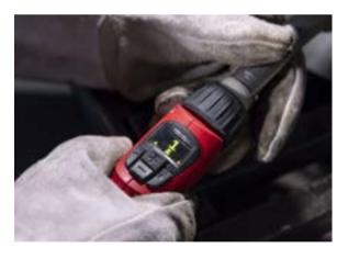
MIG/MAG 和 TIG 焊接中的焊枪导航功能: 用户只需使用焊枪触发装置即可在工作 时操作软件。
