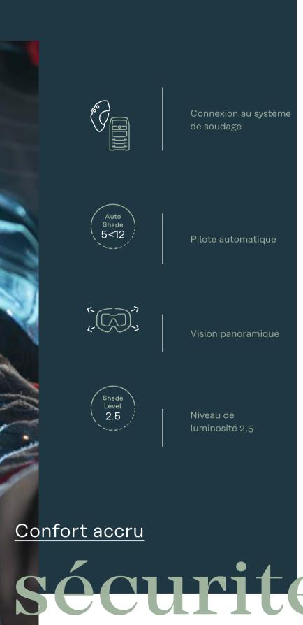
Grâce à la technologie Bluetooth® Low Energy, la cagoule de soudage est déjà pilotée par le système de soudage avant l'amorçage de l'arc électrique. La cellule reste assombrie de façon extrêmement fiable, même à des intensités très réduites et dans des positions difficiles.
