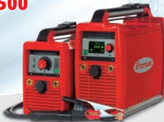
/ Os TransPocket 2500/3500 são os aparelhos ideais para o emprego em canteiros de obra e na produção. Seu peso e a alça de carregamento de série tornam-no móvel, a sua robustez torna-o à prova de choques e indestrutível. As fendas de ar colocadas mais altas não deixam penetrar água, o filtro de pó integrado protege contra sujeira de forma confiável.
